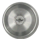
G1シリンダー 耐ピッキング：10分以上 耐鍵穴破壊し：5分未満
